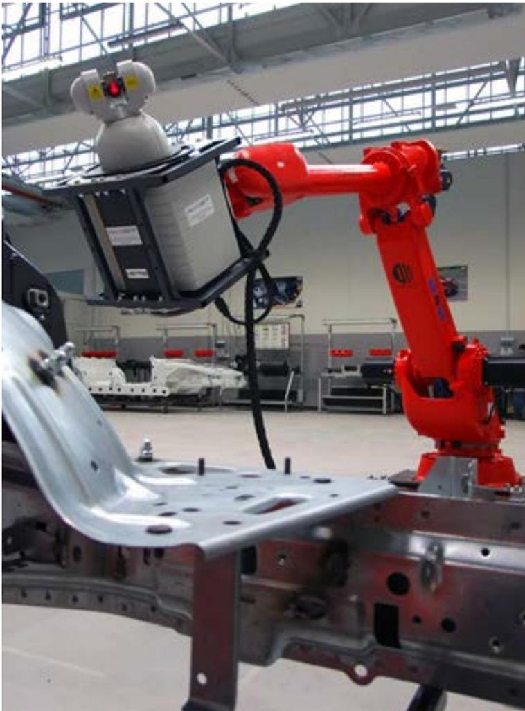
La misura di un componente in linea di grandi dimensioni può essere misurato integrando un Laser Radar con un robot antropomorfo.
