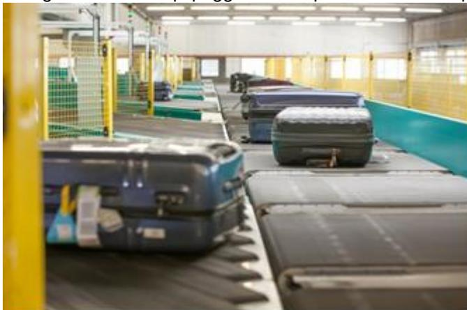
Queste caratteristiche di allestimento, la versatilità della configurazione e le elevate prestazioni di smistamento offerte (portate meccaniche - Bagagli fino a 10.000 celle/h e Pacchi fino a 18.000 celle/h) collocano i sistemi di sorting Leonardo al vertice dei segmenti di mercato, rispettivamente, dei sistemi BHS per grandi aeroporti (oltre 20M passeggeri/anno) e dei sistemi MHS per HUB Logistici.
