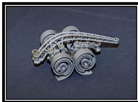
Supporto di antenna elastico fatto in titanio
