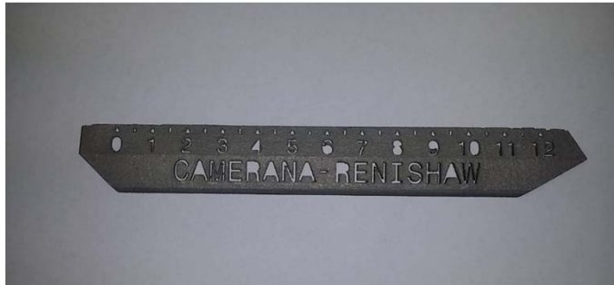
Righello realizzato con tecnologia additiva
