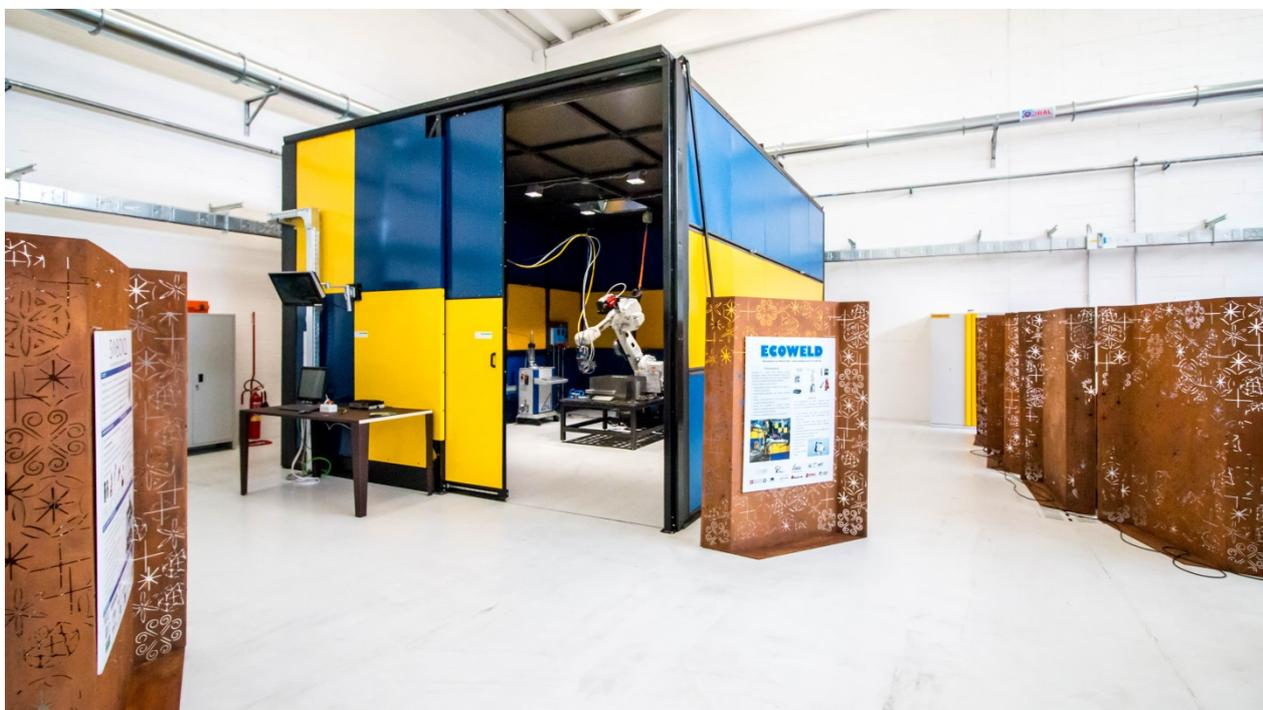
Il sistema di saldatura laser robotizzato realizzato nell'ambito del progetto ECOWELD
